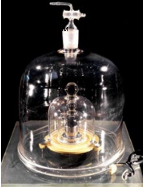
Цилиндр из платино-иридиевого сплава, до недавнего времени служивший эталоном килограмма.
